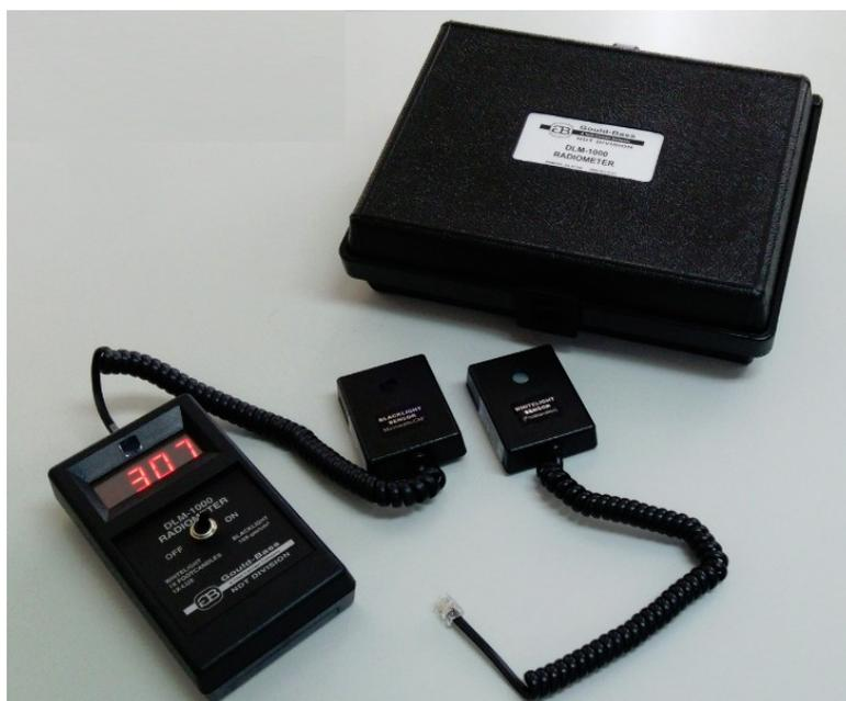
米国 Gould Bass 社製紫外線強度計 DLM-1000 は、320-380nm の紫外線強度を計測でき、センサーを交換する事によって、380-700nm の白色光（Lux 表示, Foot candle 表示）も測定でき、全てデジタルにて表示されます。この DLM-1000 は、最新の LSI 回路とディスプレイ技術により設計されており、部品数は最小限で構成され、信頼性、正確性、安定性といった基本ファクターを満足しております。又、ディスプレイに採用している LED は、暗室化でも判読が容易です。
