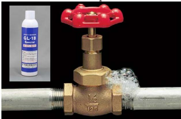
検査剤をそのまま塗布するだけで、泡立ちが微量なガス漏れを素早くキャッチします。各種タンク類や配管系統のガス漏れ検査に広く使用されています。なお、GL-1B Special は、検査物がオーステナイト系ステンレス鋼、チタン合金、ニッケル合金などの時に使用します。
