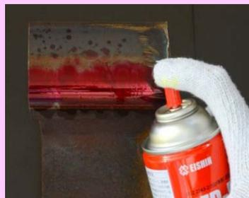
ワーク表面の余剰浸透液を空ウエスにて拭き取り、その後洗浄液を適用したウエスにて残っている余剰浸透液を拭き取る。
