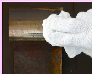
浸透液を適用し、**10分静置**させる。
